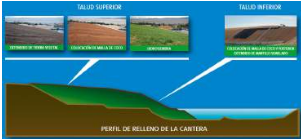
Figura 2. Perfil de relleno de la antigua cantera
